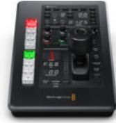
Das ATEM Micro Camera Panel ist ein tragbares Kamerapult mit Broadcast-CCU-Steuerelementen der Spitzensklasse. Steuern Sie mit diesem Panel bis zu vier Kameras gleichzeitig, inkl. Einstellungen wie Blende, Schwarzabhebung, Verschlusszeit, Weißabgleich, Master-Gain, RGB-Abgleich und mehr. Lässt sich per Bluetooth oder USB-C mit ATEM Software Control verbinden.
