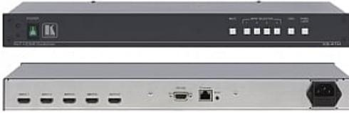
VS-41H ist ein Hochleistungs-Umschalter für HDMI-Signale. Er entzerrt und schaltet einen von vier Eingängen auf den HDMI-Ausgang durch
